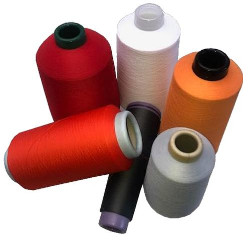
**Polyestergarne erzeugen tiefe Kerben nach kurzer Zeit – dadurch häufige Platinenwechsel!**
